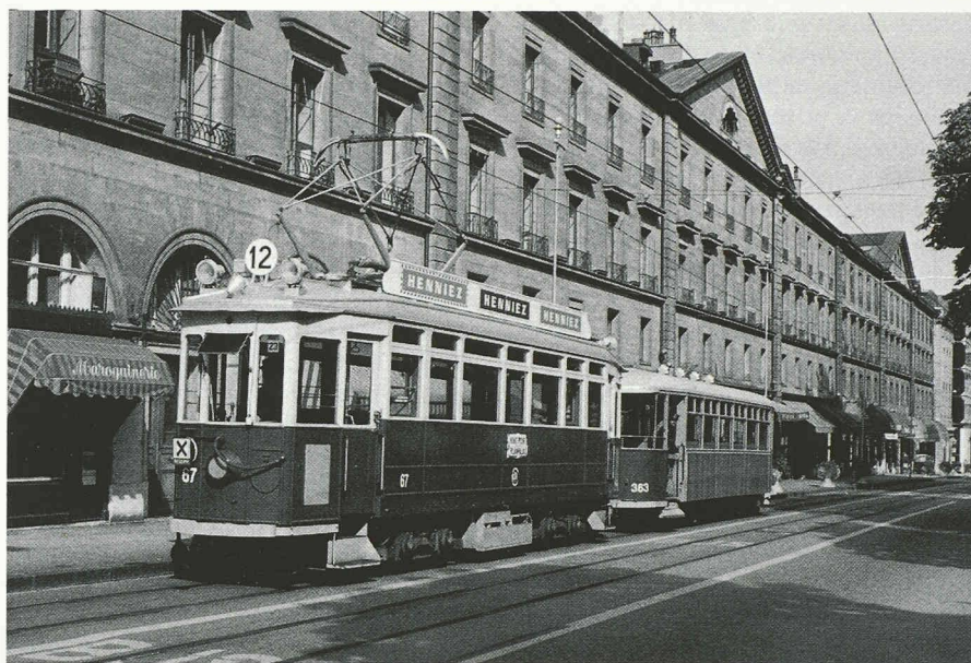
Fig. 6. — Le train de l'Association genevoise du Musée des tramways (AGMT) au printemps 1984, à la rue de la Corraterie, devant une rangée d'immeubles du XIX e siècle. Quelques caractéristiques : automotrice Be 4/4 67, construite en 1934 à Genève selon une technique de 1920 (châssis soudé et caisse en bois) en une série de 15 véhicules réutilisant des bogies de 1901 et des moteurs de 1907, vitesse maximale 30 km/h, puissance unihoraire 132 kW à 19 km/h ; remorque Bi 363 construite en 1920 par la Société industrielle suisse (SIG) en une série de 10 véhicules ; c'est l'un des premiers véhicules à caisse allégée pour un chemin de fer à voie étroite en Suisse. Le convoi est entretenu par l'AGMT mais demeure la propriété des TPG et est en état de marche. L'automotrice se trouve présentement dans son état de 1950 (peinture selon l'ordonnance de 1946 et pantographe usuel depuis 1950) et la remorque se trouve dans son état de 1931. Voudrait-on remettre les véhicules dans leur état d'origine, cela poserait quelques problèmes : s'il est relativement facile de reconstituer pour l'automotrice son ordonnance de peinture de 1934, il serait en revanche plus difficile de lui redonner deux perches comme prises de courant et de circuler actuellement. Pour la remorque, l'état de 1920 est difficilement réalisable : en 1931 les panneaux métalliques latéraux, souvent enfoncés lors de collisions avec des automobiles, furent recouverts de lames en pitchpin, lesquelles restèrent les premières années dans leur couleur naturelle. Cet exemple montre que la remise en l'état d'origine de véhicules historiques doit être nuancée. Lorsque plusieurs véhicules différents sont destinés à former un train, leur apparence respective devrait correspondre. Ainsi, lorsque l'AGMT pourra disposer d'un endroit couvert pour abriter son train, actuellement garé en plein air devant la gare de Chêne-Bourg, elle pourra envisager de remettre la machine 67 dans son état de 1934 avec des filets décoratifs. Seul le pantographe constituera un anachronisme formel forcé !
