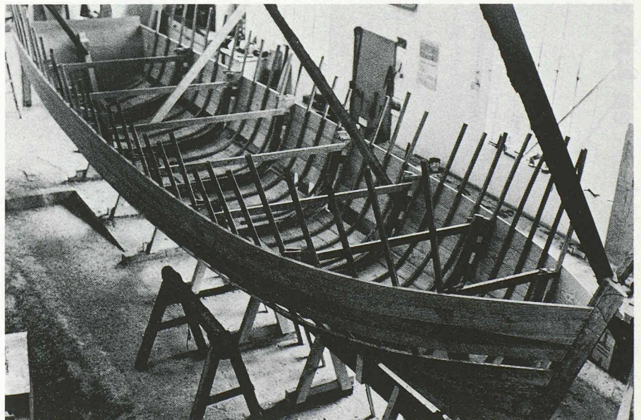
Fig. 10. — Le canot a reçu ses «courbes» en acacia ployé à la vapeur.
