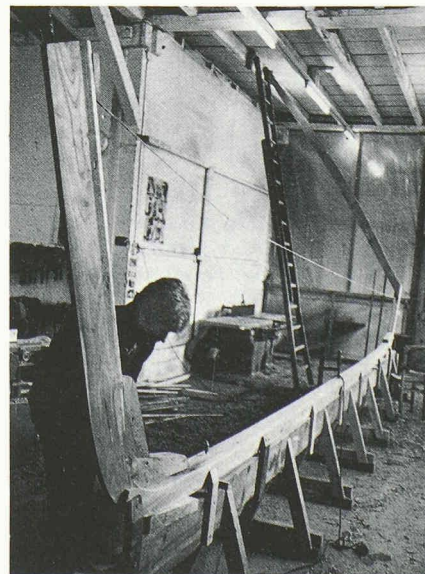
Fig. 8. — Mise en chantier d'un canot chez Sartorio à Mies. L'étrave, la quille et le marsouin (pièce de bois fixant le tableau sur la quille) sont assemblés et alignés.
