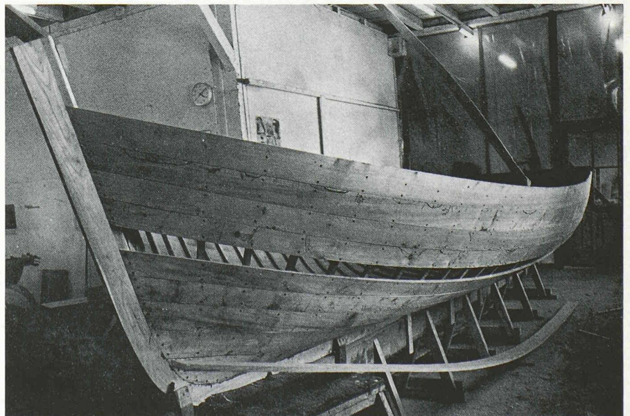
Fig. 11. — Les gabarits ont été enlevés et les «courbes» arasées. Il reste à poser un bordage de chaque côté. Les constructeurs appellent les clés ces bordages posés en dernier lieu, et dont l'absence pendant la fin de la construction facilite la mise en place des «courbes».
