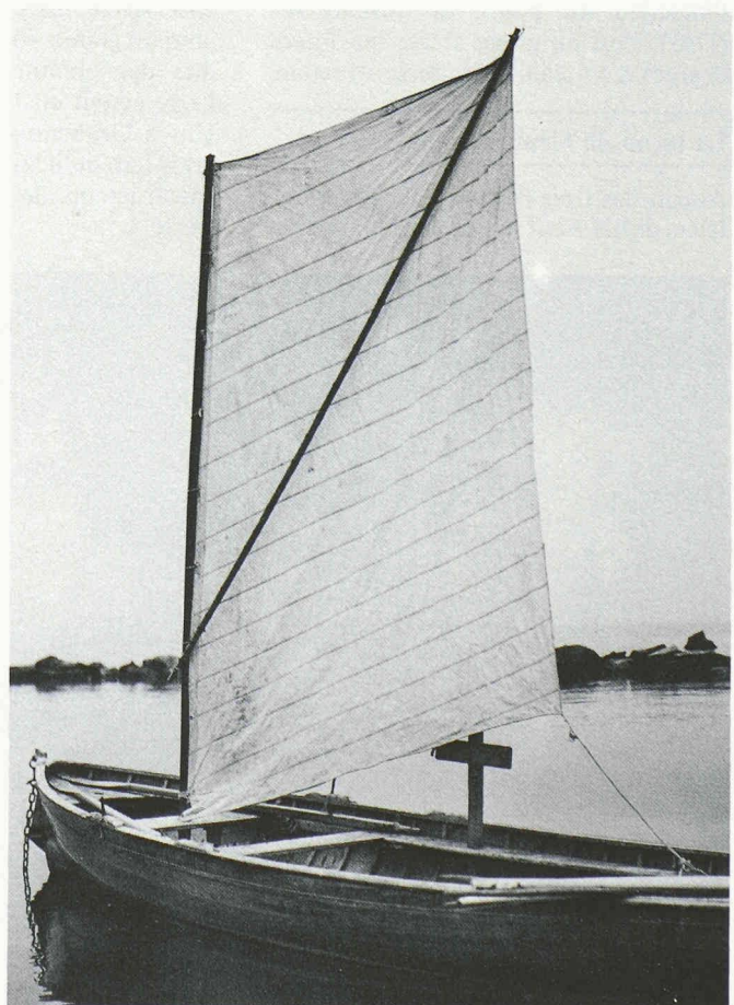
Fig. 3. — Canot de pêche gréé d'une voile à livarde.
