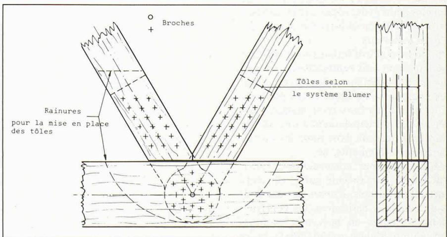
Fig. 6. — Assemblage par broches et goussets métalliques.
