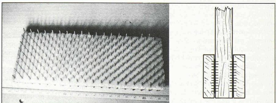
Fig. 5. — Plaque à aiguilles type Menig.
