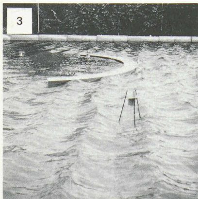
Fig. 4. — Vue de l'installation d'essai en cours d'essais : 1. Vue d'ensemble ; 2 et 3. Vue du champ de vagues pour 2 fréquences distinctes ; 4. Creux locaux importants dus à la combinaison de l'émission propre et des vagues transmises.
