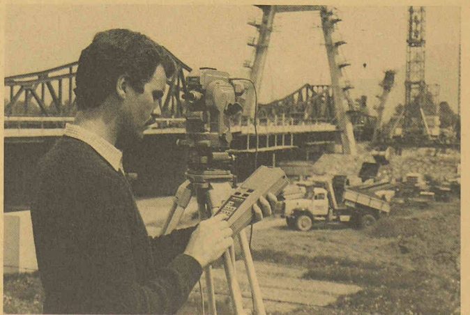
L'emploi du terminal de données GRE3 Wild se fait conjointement aux instruments de géodésie opto-mécaniques (théodolites, niveaux, lunettes zénith-nadir) pour l'introduction manuelle des données, mais aussi conjointement aux instruments électroniques pour enregistrement automatique des données.
