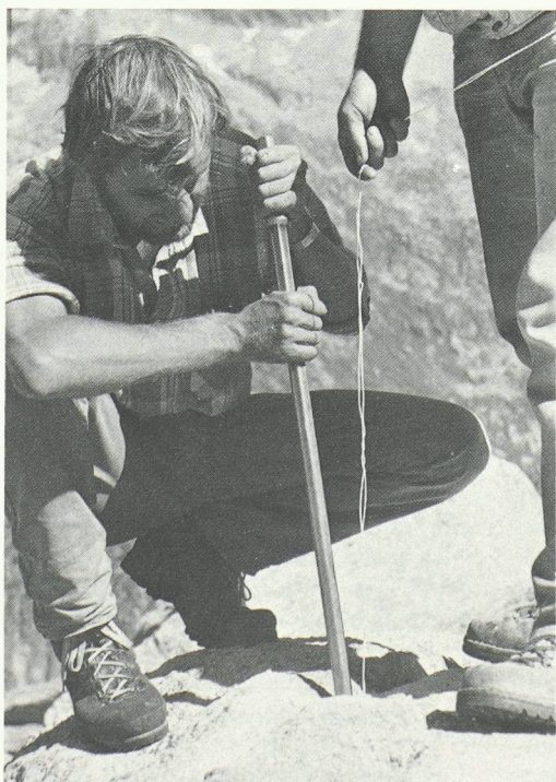
Afin de «radiographier» avec des ondes acoustiques les environs du laboratoire souterrain de la Cédra au Grimsel, on y a fait détoner de faibles charges explosives. Ce même procédé sera également utilisé pour les sondages en vue du stockage final des déchets de faible et moyenne radioactivité. (Cédra.)
