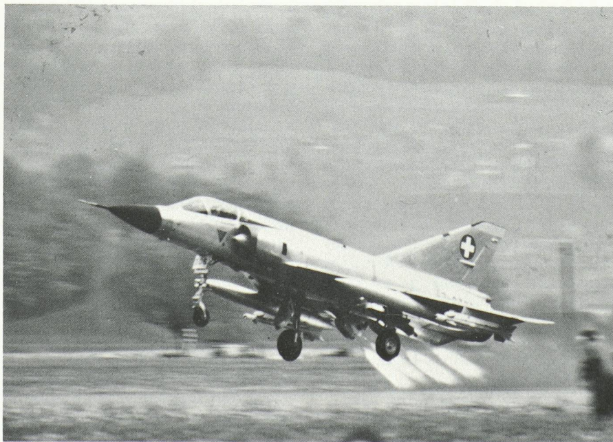
Une vilaine affaire pour un bon avion: le Mirage III S (décollage court à l'aide de fusées d'appoint à poudre Jato).
