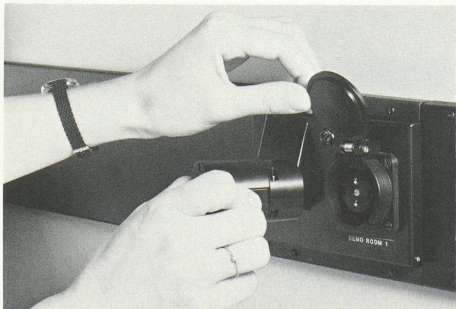
Fig. 1. - Connecteur optique - Le connecteur relie au circuit deux fibres optiques (lignes d'entrée et de sortie de chaque dispositif). L'extrémité des fibres comporte comme embout un tube métallique de 2,5 mm de diamètre : la surface extérieure de ce tube et le cœur de la fibre (100 µm) sont concentriques. Un mécanisme de guidage permet de positionner avec précision les paires d'embouts l'un en face de l'autre. La fiche sert également de connexion électrique pour actionner le relais optique.
