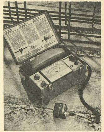
Une entreprise suisse a développé un nouvel instrument de mesure — le Profometer — dont le domaine de mesure a été élargi à cet usage. Le Profometer dispose de deux sondes de mesure avec chacune des caractéristiques de mesures différentes.
