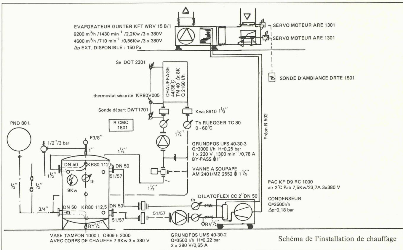
Schéma de l'installation de chauffage
