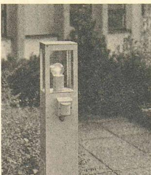
110° pour chaque plan, une zone latérale d'environ 5 m et une zone frontale de 15 m. L'éclairage s'enclenche dès que se produit un mouvement de passage dans la zone surveillée, accompagné du rayonnement de la chaleur d'un corps. Cet interrupteur automatique évite de tâtonner dans le noir quand on rentre chez soi ou qu'on en sort, c'est aussi une protection efficace contre de possibles intrus.
