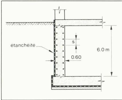
Fig. 7. — Coupe en travers d'un sous-sol de bâtiment.
