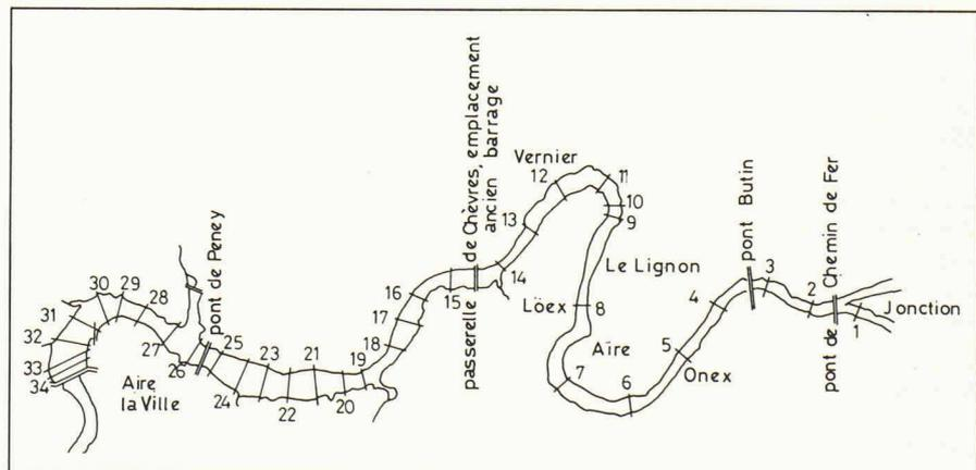
Fig. 1. - Retenue de Verbois - Plan avec profils en travers. Verbois reservoir - Contour at retention level and cross-sections.
