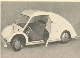
«L'atelier des idées»: maquette de la première petite automobile avec sièges-couchettes et pare-brise panoramique (1936).
