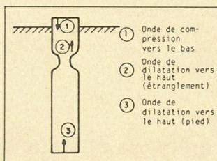
flexion est la solution optimale pour contrôler l'intégrité des pieux.
