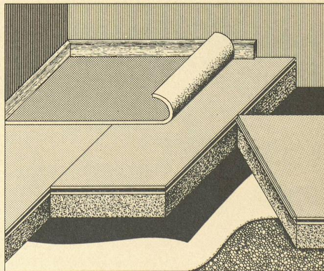
Construction d'un plancher sec en panneaux d'isolation Pavatex Duro.
