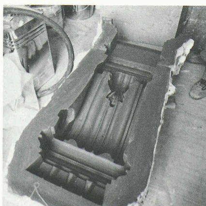
Moule d'une console de fenêtre.
