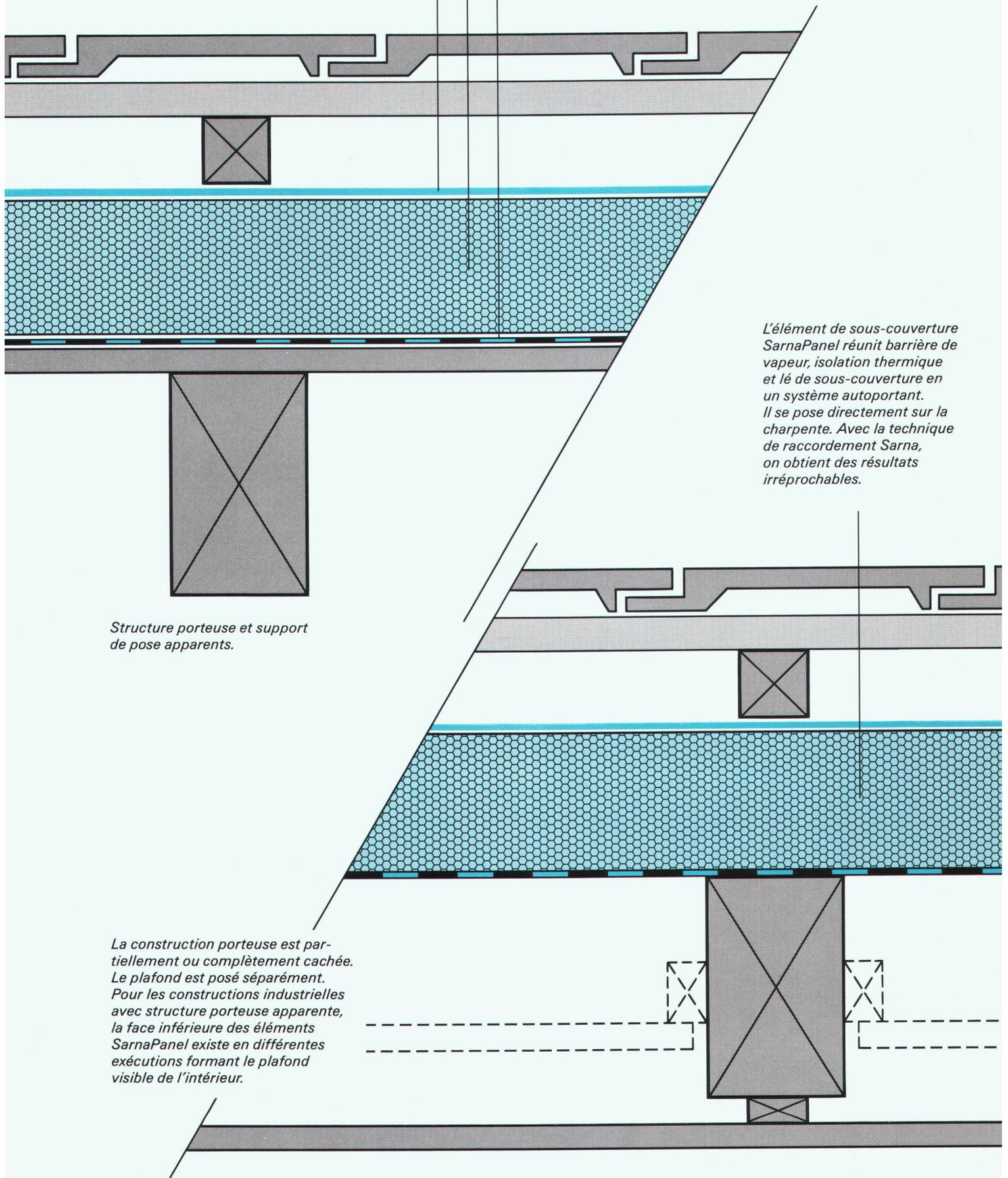
*L'élément de sous-couverture SarnaPanel réunit barrière de vapeur, isolation thermique et lé de sous-couverture en un système autoportant. Il se pose directement sur la charpente. Avec la technique de raccordement Sarna, on obtient des résultats irréprochables.*
