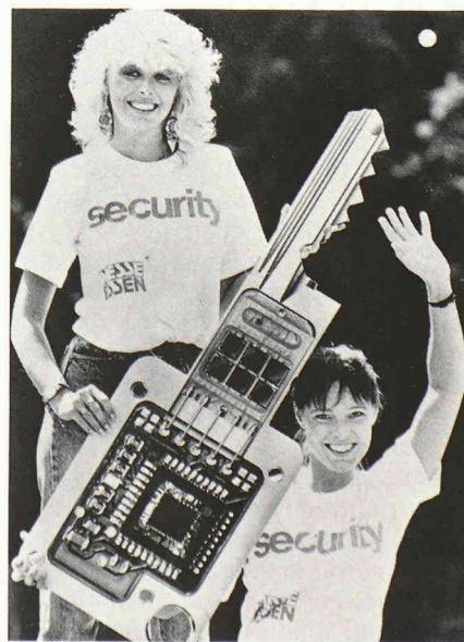
Cette clé à module incorporé dispose d'un codage à programmation fixe et ne peut avoir de double. Elle sert à actionner des serrures électroniques. (Photo INP/dpa.)
