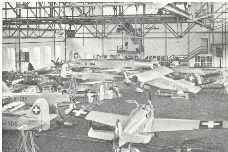
La halle de montage de Pilatus en 1950. Les P2-06 en cours de fabrication y avoisinent le prototype du P-4 ainsi que des avions civils et militaires venus à Stans pour des travaux d'entretien.
