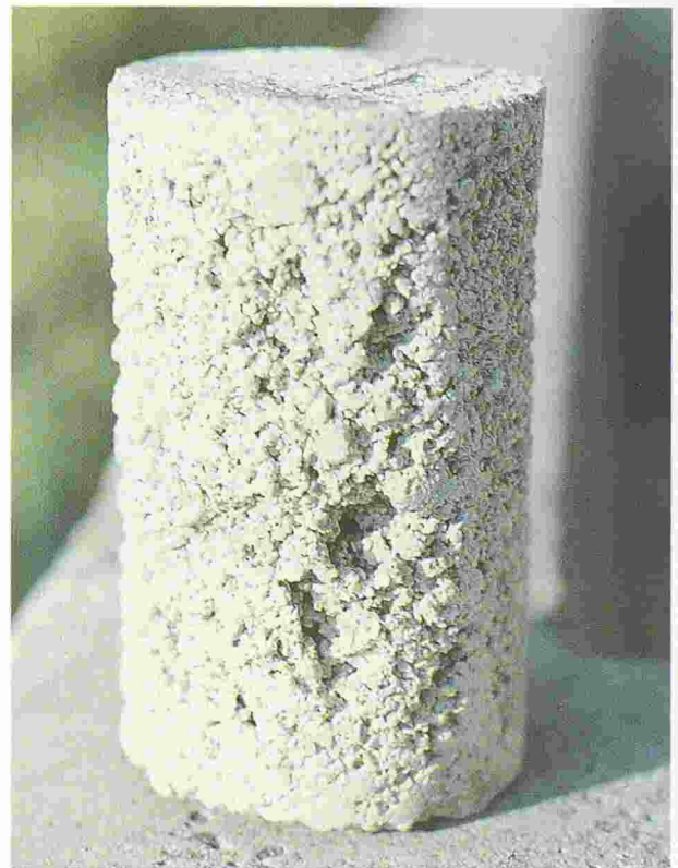
Fig. 5. – Carotte montrant la partie inférieure caverneuse et peu résistante.
