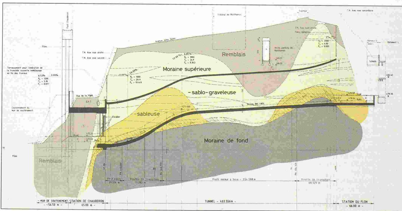
Fig. 1. - Tronçon Flon-Chauderon: profil en long géologique.
