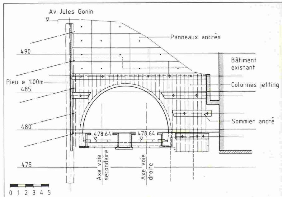
Fig. 4. - Station de Lausanne-Flon : paroi épinglée ouest.
