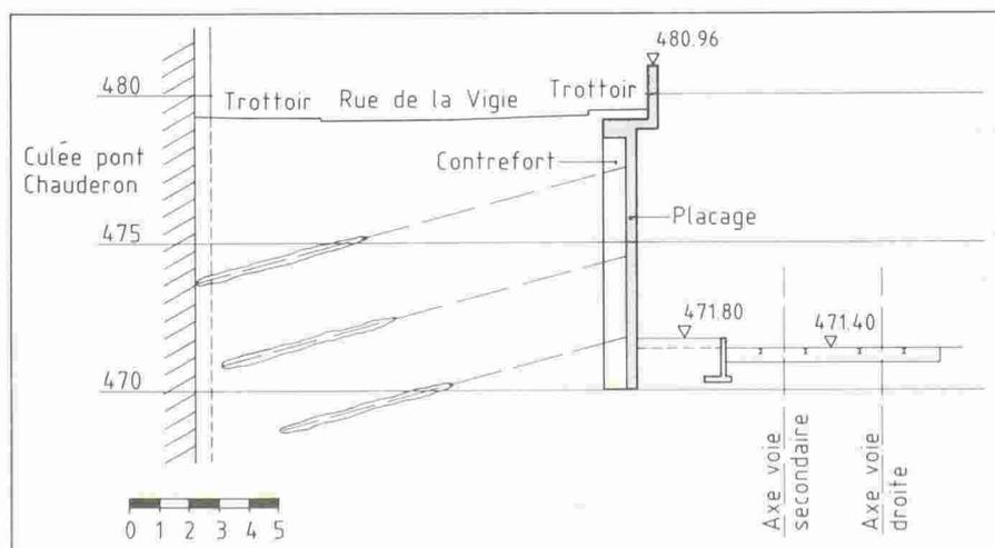
Fig. 12. - Mur ancré de Chauderon: coupe.
