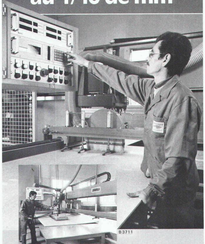
C'est en effet la précision extraordinaire que nous pouvons vous offrir avec notre nouvelle installation de coupe (trait de coupe au laser). La commande numérique est capable d'enregistrer plus de 200 mesures, ce qui en fait un outil de travail performant et fiable. Ainsi vos commandes sont traitées dans des délais encore plus brefs.
