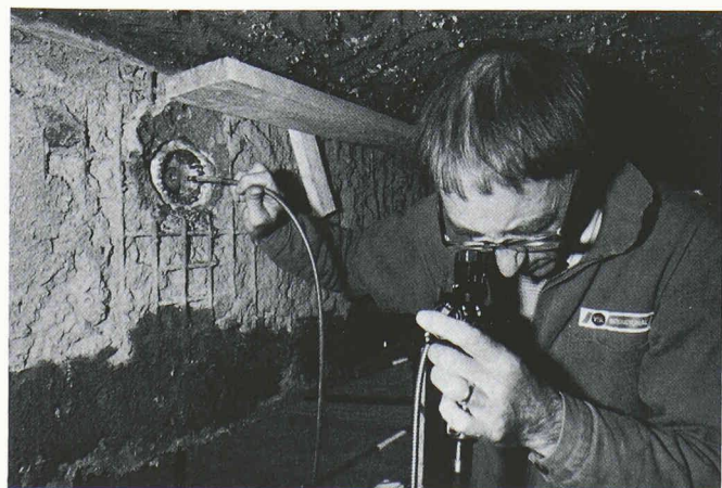
Fig. 6. - Auscultation à l'endoscope.
