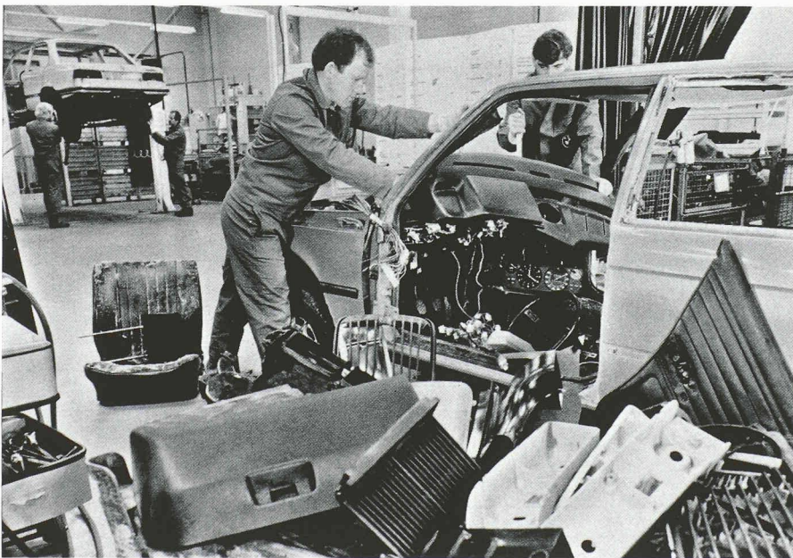
Poste de démontage à des fins de récupération chez BMW.
