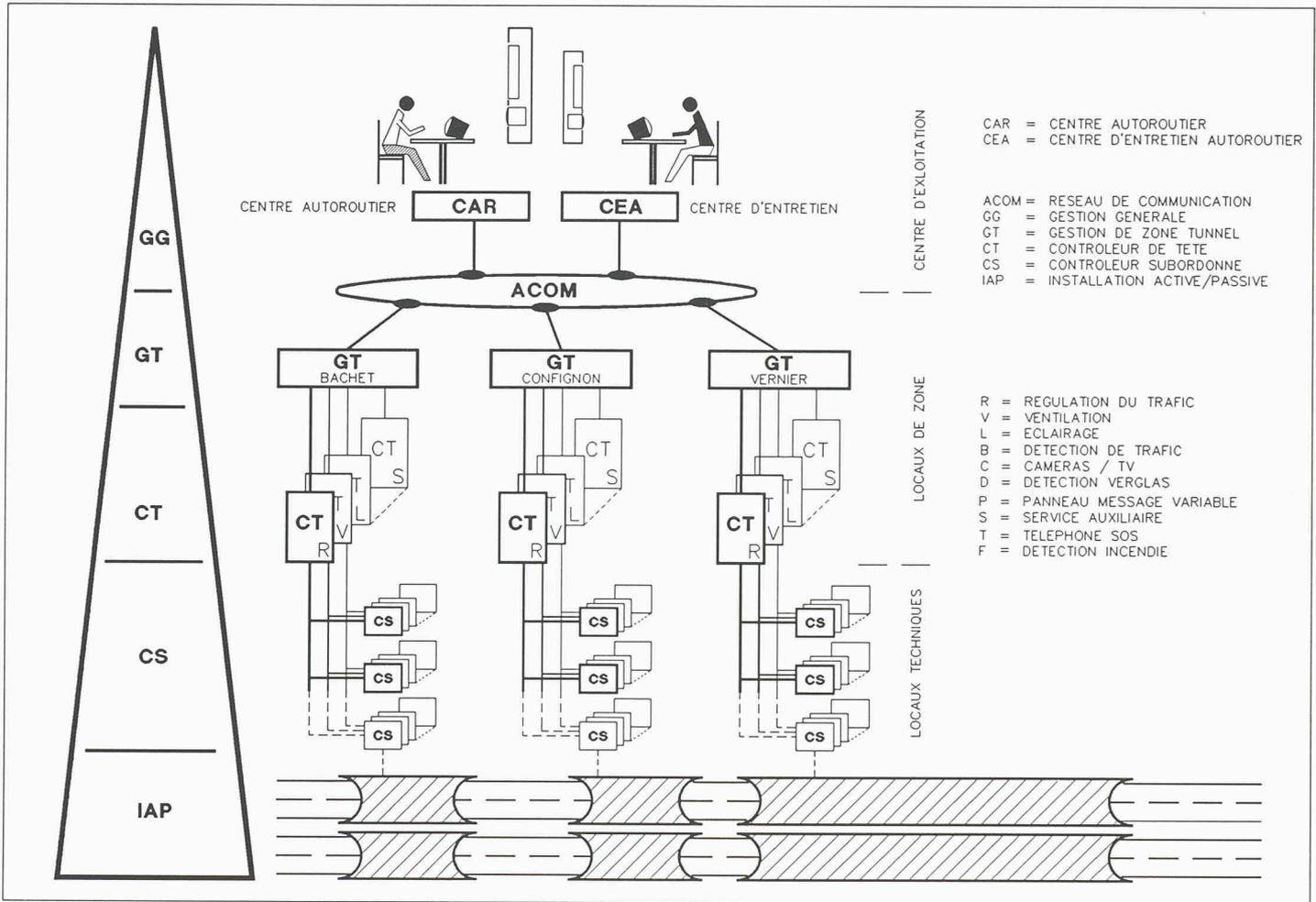
Fig. 1. — Architecture générale du système de contrôle et commande de l'autoroute de contournement
