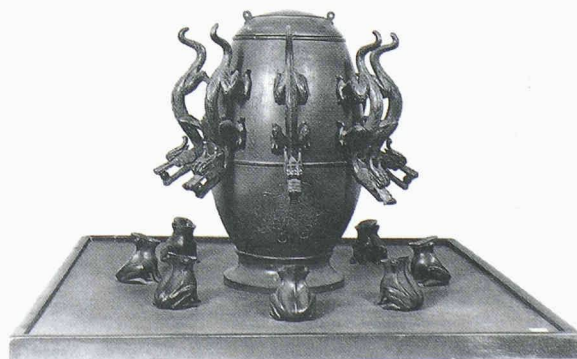
Sismographe inventé en l'an 132 par le savant Zhang Heng. A l'intérieur de l'urne, un pendule réagit aux secousses et déclenche un mécanisme qui fait lâcher à l'un ou l'autre des dragons une bille en bronze destinée à tomber dans la gueule d'une grenouille.
