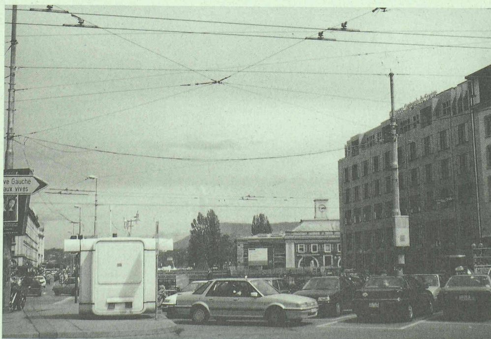
Fig. 3: Stations de mesures ROPAG. L'air est prélevé à 2,5 m de hauteur et analysé automatiquement au moyen d'appareils spécifiques. Un système d'acquisition de données enregistre les valeurs toutes les cinq secondes
