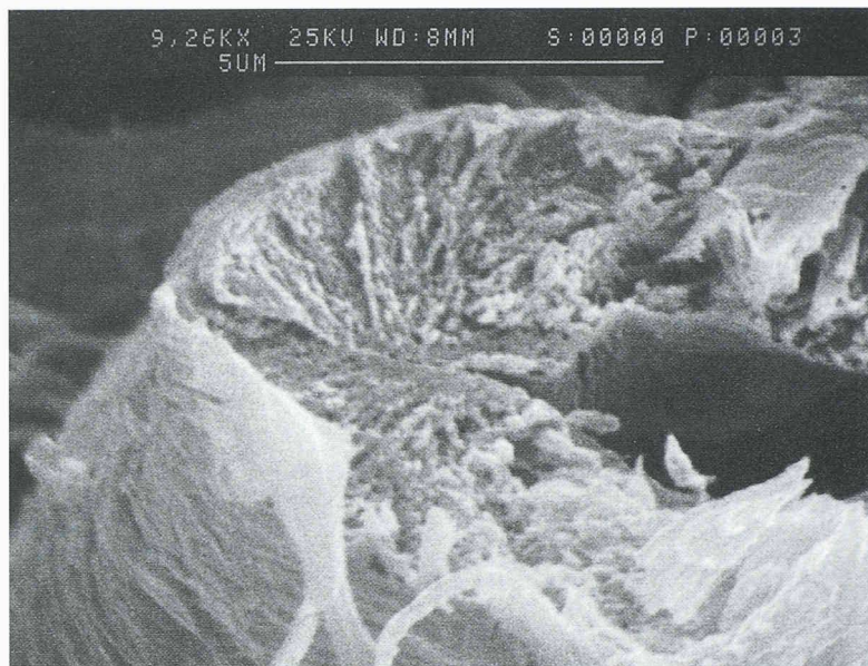
Fig. 15. - Ecrasement d'une cellule de bois après traitement thermomécanique, photographie prise au microscope électronique à balayage
