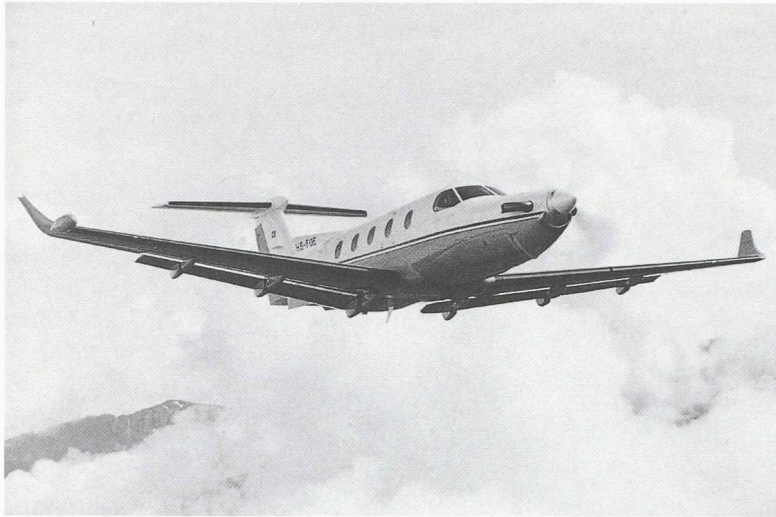
Le PC-12 en vol. On remarque les volets hypersustentateurs de grandes dimensions qui permettent de combiner une vitesse de croisière élevée avec la faible vitesse de décrochage prescrite par les normes d'homologation.
