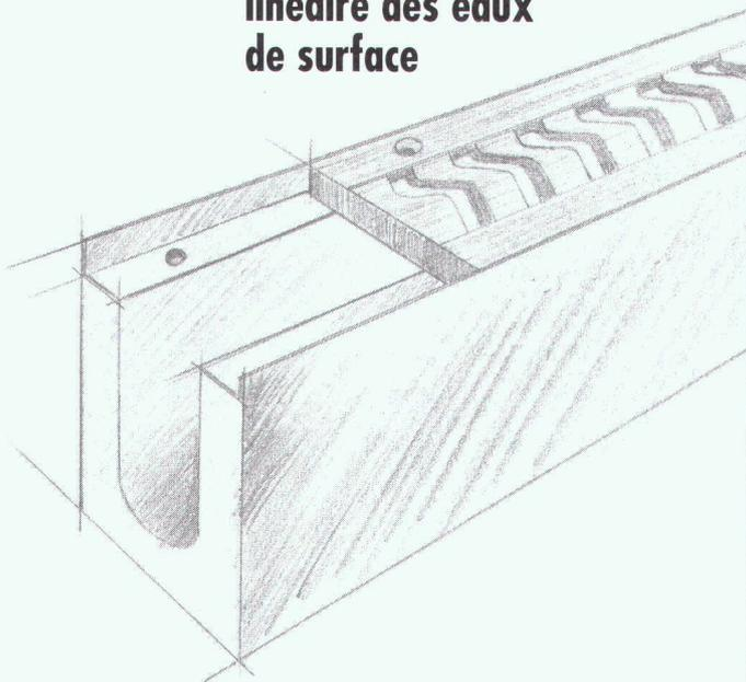
Même un transport de fort tonnage ne peut rien contre une cunette Securro. Dans leur exécution la plus performante, les cunettes en béton, munies de grilles en fonte solidement fixées résistent aux charges de roue de 25 tonnes.
