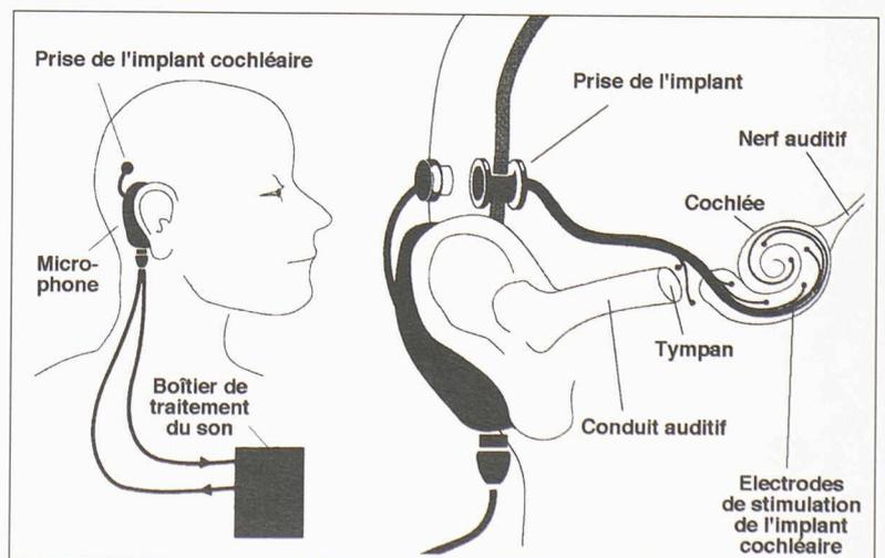
Fig. 1 - Schéma d'un implant cochléaire
