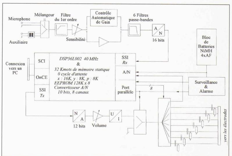
Fig. 4 - Schéma électronique général du dispositif portable
