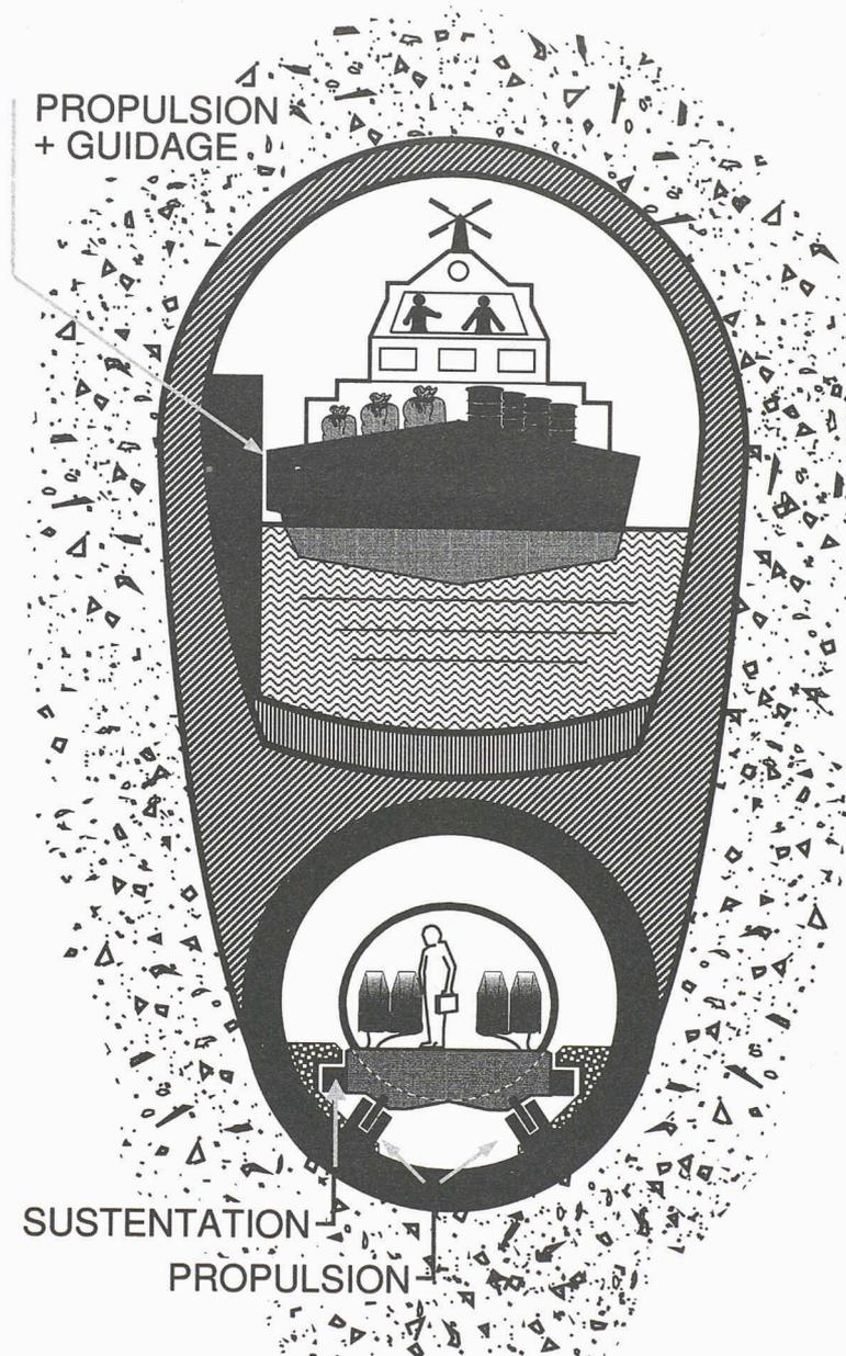
Fig. 6.- Coupe type d'un tunnel combiné Swissmétrô-navigation
