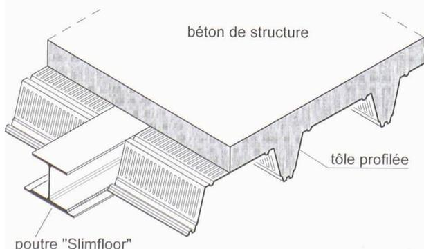
Fig. 6.- Tôle profilée pour « slim-floor »
