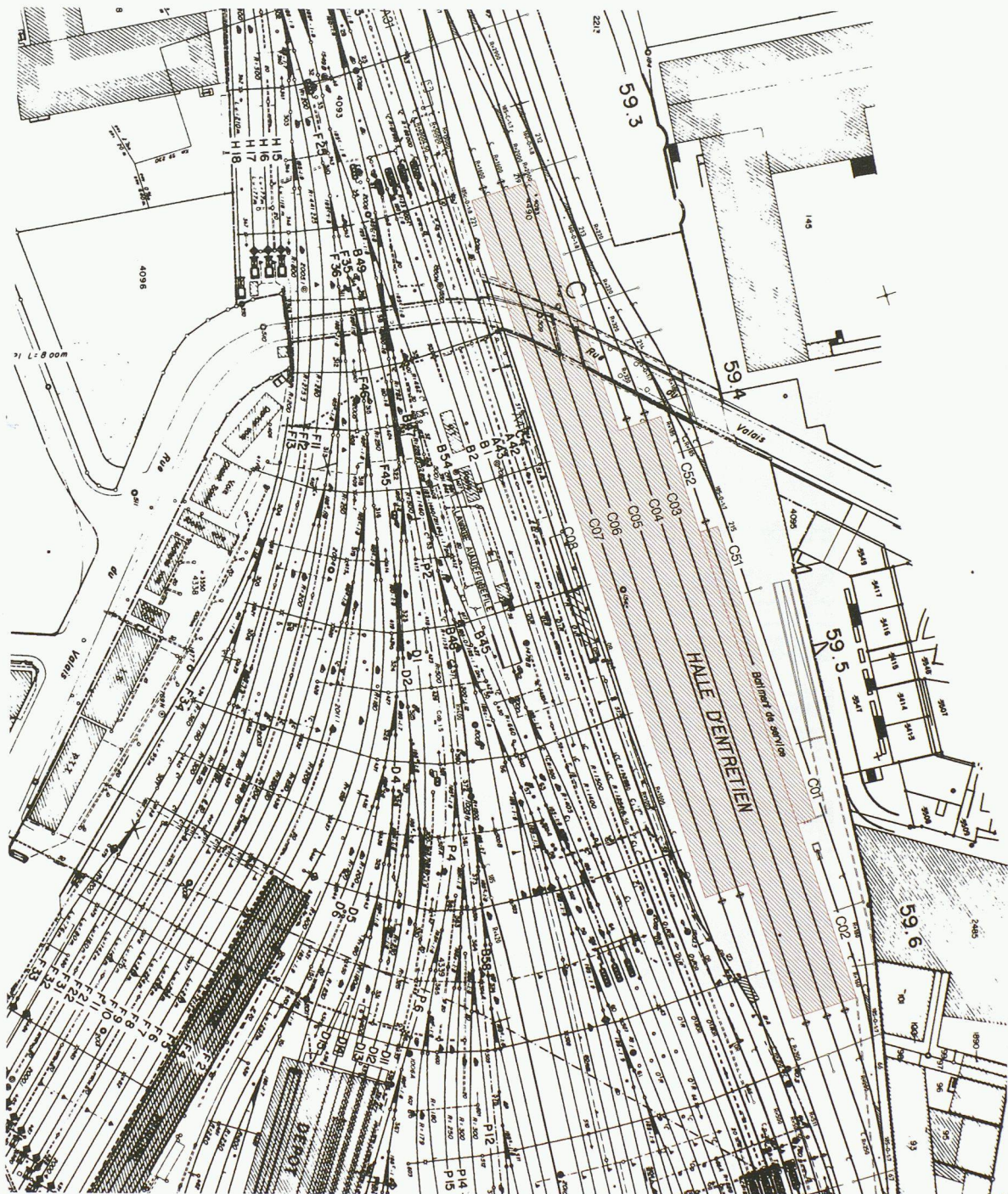
Fig.2. Plan général des voies à Cornavin
