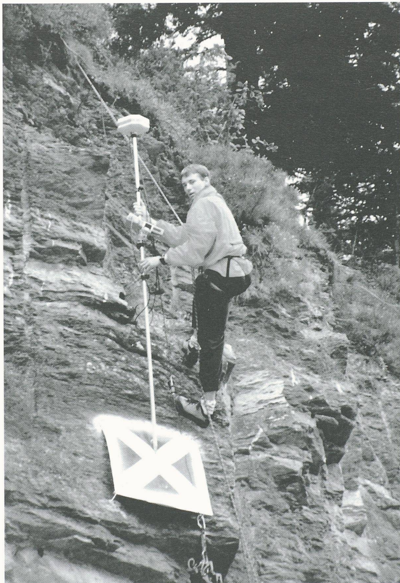
Fig. 2. - Mesures de points topographiques pour une étude des avalanches dans la vallée de la Sionne (VS). Sont visibles le récepteur GPS et une balise pour la photogrammétrie (Photo EPFL)
