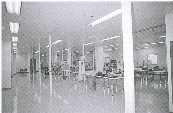
Fig. 2: Vue d'un banc de montage. A noter la présence d'aspirateurs orientables qui permettent d'éliminer une partie de la contamination à la source. Bien que coûteuses, les surfaces vitrées améliorent sensiblement les conditions de travail et permettent de montrer les installations aux visiteurs.
