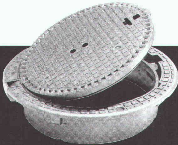
Classe D400, E600 et F900 avec ou sans verrouillage (ventilé ou non en D400).
