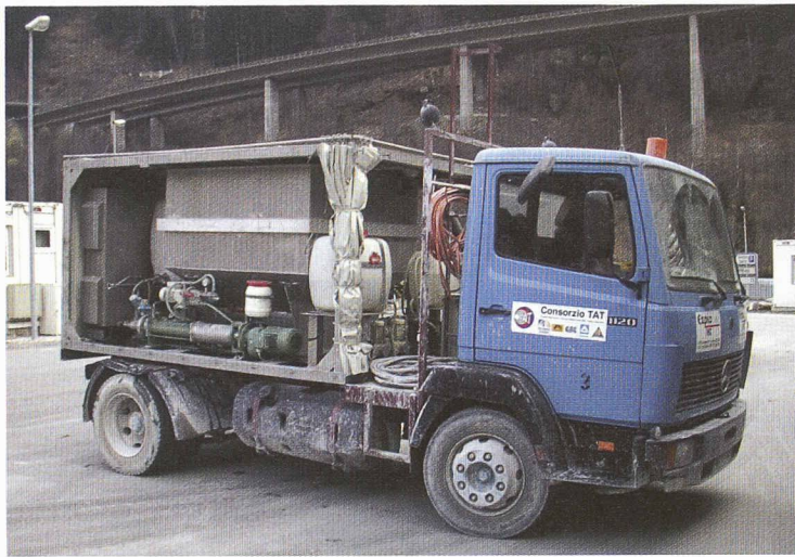
Fig. 2 : Chargement de l'explosif
