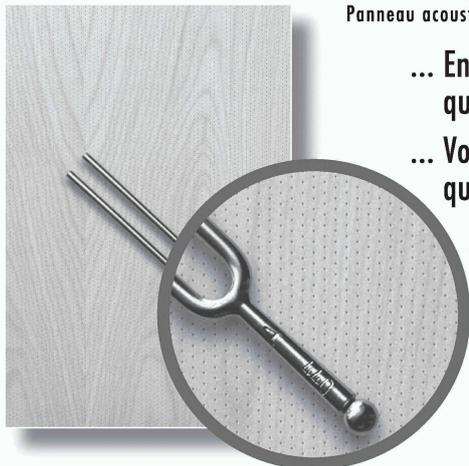
La surface de cet élément en bois retient l'attention par les très petits trous, d'un diamètre de seulement 0,5 mm. La micro perforation est à peine visible, même à courte distance. RONDOLÒ® avec une surface ouverte de seulement juste 5,7%, atteint effectivement, une incroyable absorption de sons. Le coefficient NRC d'absorption de sonorité, correspond au chiffre formidable de 0,8.
