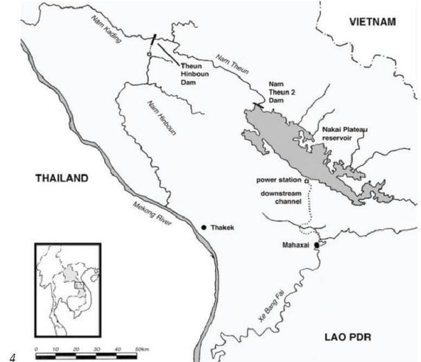
n'était pas acceptable de rejeter sans autre précaution un important volume d'eau dans une rivière qui n'était pas faite pour le recevoir, un canal de 27 km a été conçu pour amortir l'impact des rejets dans la Xe Bang Fai et éviter les problèmes d'érosion. La vigilance de tierce partie est souvent essentielle pour résoudre des problèmes et amener des améliorations.
