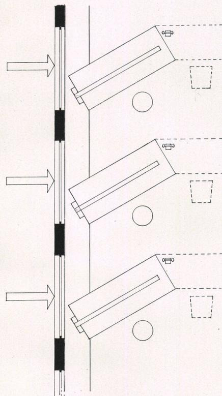
Aufbau-Schema für liegende Zeichenbretter in einem Bauatelier: Lichteinfall - Winkel 60 Grad, bei stehenden Zeichentischen 30 Grad, gute Beziehung von linksseitigem Tischrack . . . über Zeichenbrett . . . zum Kurzschreibtisch. Gute Ausnutzung der verbindenden Schräglflächen für Zeichenmaterial und Telefon. Tischanlage frei im Lichtfeld stehend.
