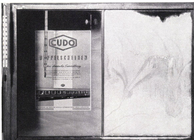
Diese Aufnahme von einer Versuchsanordnung wurde gemacht bei einer Außentemperatur von +15^{\circ} und einer Innentemperatur von -15^{\circ} . Die normale Fensterscheibe rechts ist ganz mit Eis bedeckt, während die Cudo-Doppelscheibe links ihre klare Durchsichtigkeit behält.
