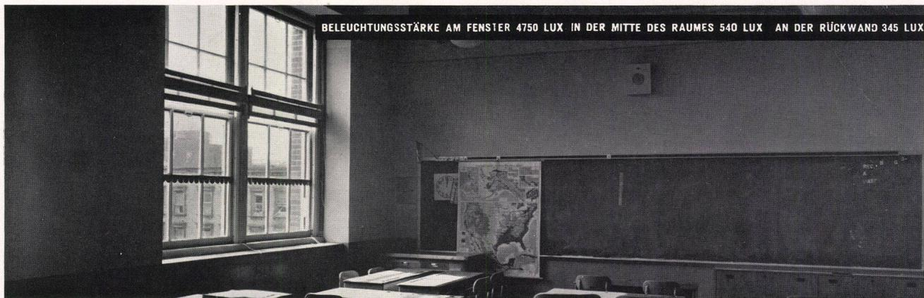
BELEUCHTUNGSSTÄRKE AM FENSTER 4750 LUX IN DER MITTE DES RAUMES 540 LUX AN DER RÜCKWAND 345 LUX
