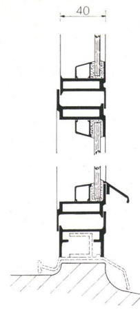
Abb. 3 Vertikalschnitt durch Drehflügelpartie vom Industrie- und Bürofenster, System «Menziken», Größe I, für Einfach- oder Isolierverglasung. Fabrikation durch die Metallbaufirmen und Schlossereien.
