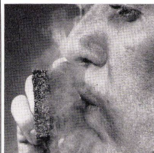
Dampfdicht – Schneiden Sie z.B. mit einem Brieföffner eine 5-mm-Scheibe vom Muster und versuchen Sie, Zigarettenrauch durchzublasen. Der Rauch dringt nicht ein: FOAMGLAS ist eine vollkommene Dampfsperre!
