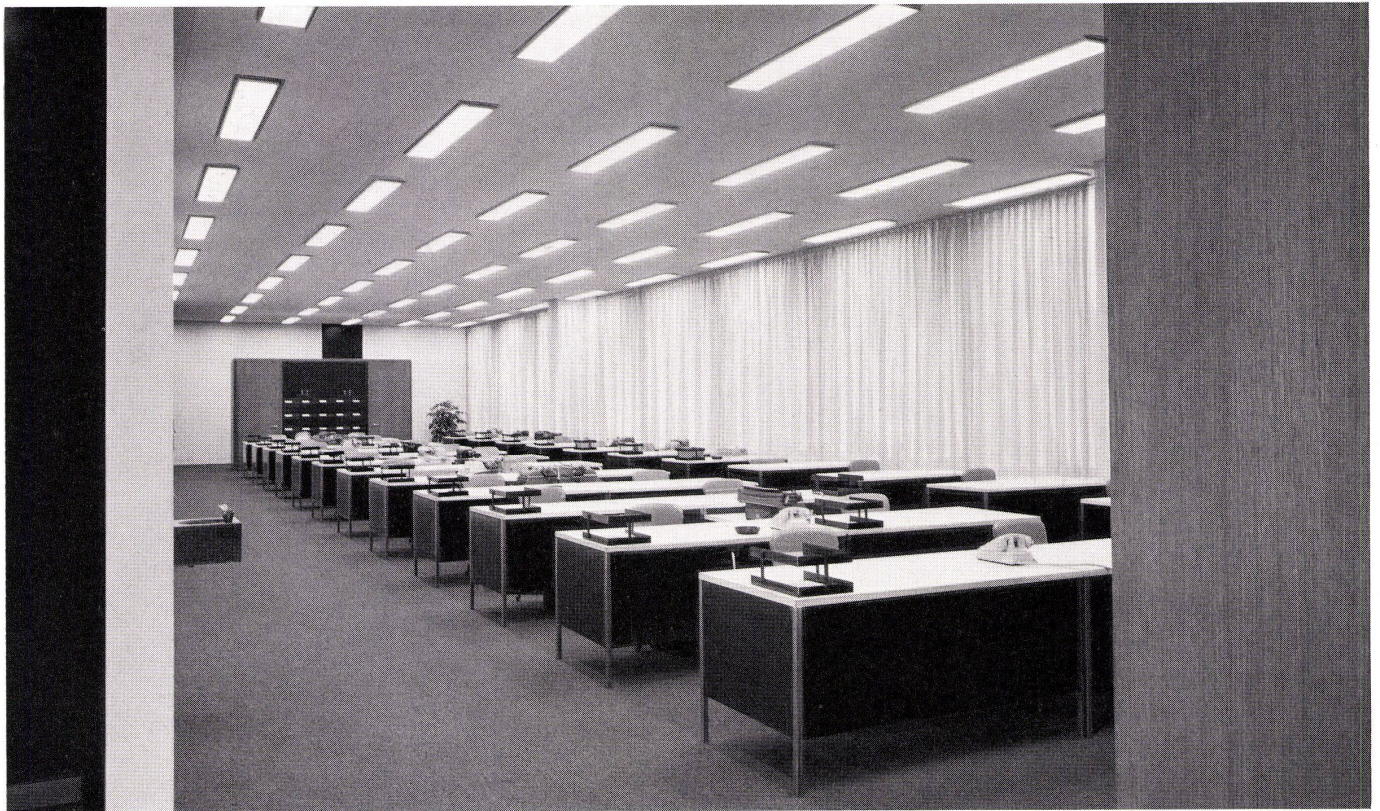
5 Großraumbüro im Gesundheitsamt, zweites Geschoß. In die Decke eingelassene Fluoreszenzleuchten mit Klimaschlitzten. Weiße Fiberglasvorhänge. Grand bureau du service de santé, deuxième étage. Eclairage fluorescent monté dans le plafond, avec ouvertures d'aération. Rideaux en fibres de verre blancs. Large office unit in the Public Health Department, second floor. Fluorescent lighting, with air vents, built into the ceiling. White fibre-glass curtains.
