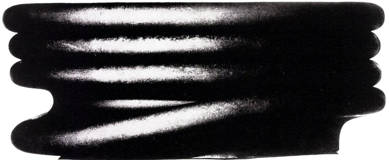
Stauchproben bilden nur einen Teil der umfangreichen Prüfungen, welche laufend während der Fabrikation von ARFA-Rohren durchgeführt werden. Sie sind ein Beweis für die Güte der Schweißung und die Verformbarkeit des verwendeten Stahls.
