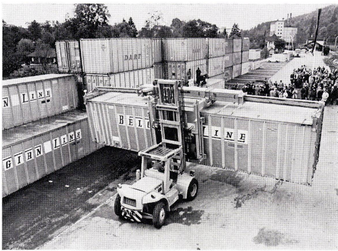
Der erste Container-Bahnhof der Schweiz. Die genormten Großtransportbehälter werden von der Straße auf die Schienen umgeladen.
