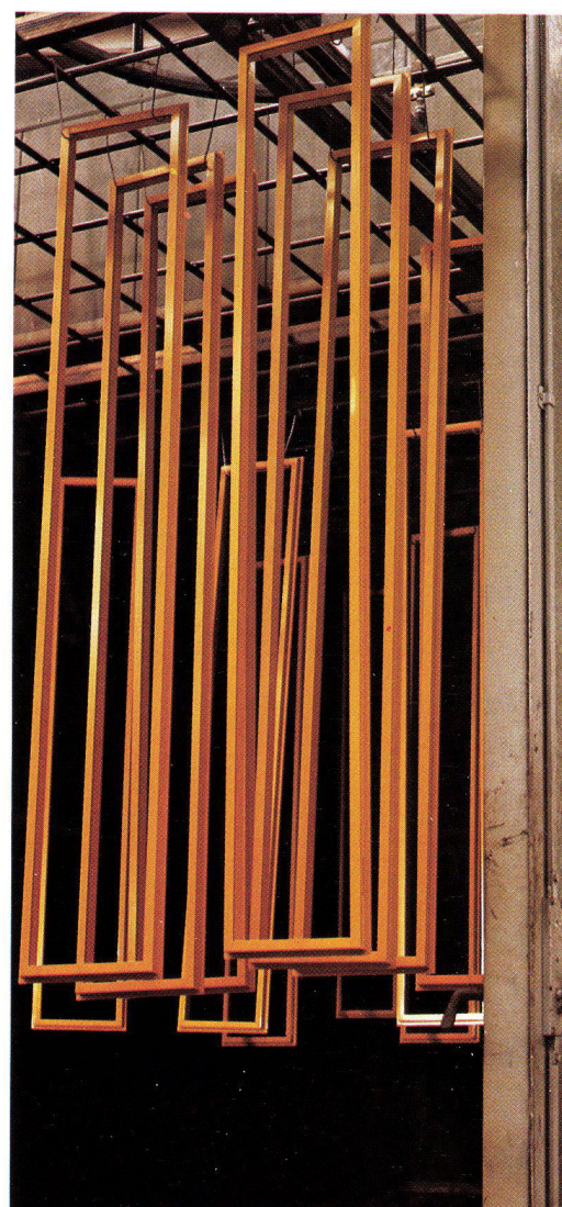
Der Bauteil gelangt in den Einbrennofen, wo der Lack bei einer Temperatur von über 190° ausgehärtet und dauerhaft mit dem Aluminium verbunden wird.
