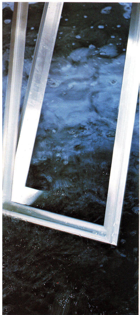
in mehreren aufeinanderfolgenden Bädern wird die oberste Schicht des Aluminiums chemisch verändert. Eine Haftschiicht entsteht, auf der ...
