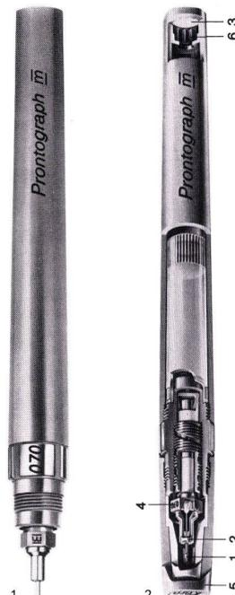
der Reihen 1  $\bar{m}$  (Mikroverfilmung) und 2 an Vorderteil und Zeichenspitze; die großzügig dimensionierte Luftaustauschöffnung im Halterschaft gewährleistet einen dauernd gleichmäßigen Tuschefluß; sämtliche Prontographenteile sind mit Teilen systemgleicher Tuschefüller kombinierbar.
